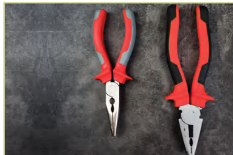
Alicate de corte - Pinza plana
