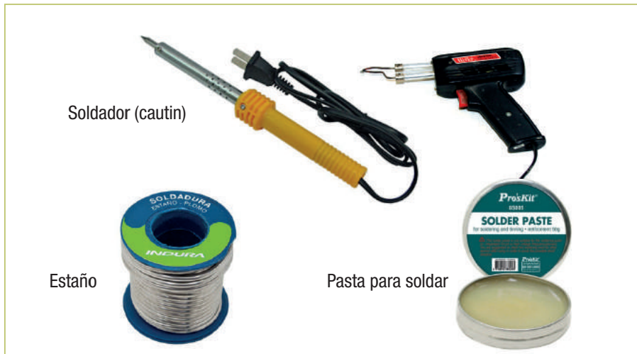
Rollo de material para soldadura, material utilizado para soldar los empalmes de los conductores, y un soldador.
